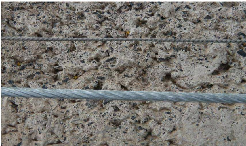
*Diferencia de diámetros en cables Collarum 3,9mm y Lazo 2mm*
